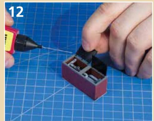
Damit jeder das Innenleben der Grube besichtigen kann, werden die Klappen in geöffnetem Zustand angeklebt.
